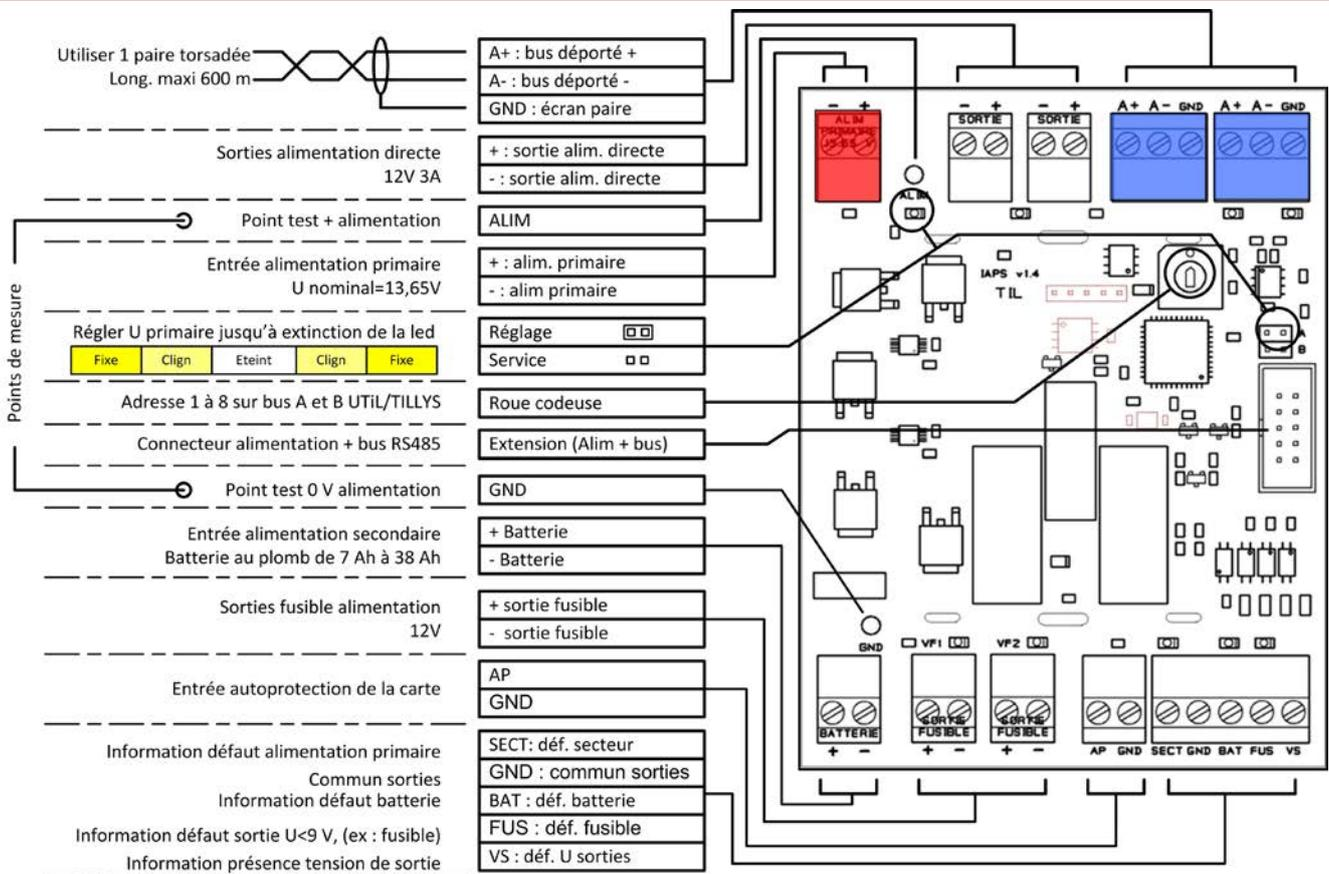
Protection des équipements : Afin d'assurer un parfait fonctionnement des équipements et éviter les interférences, raccorder le 0 volt des cartes électroniques à la terre.
